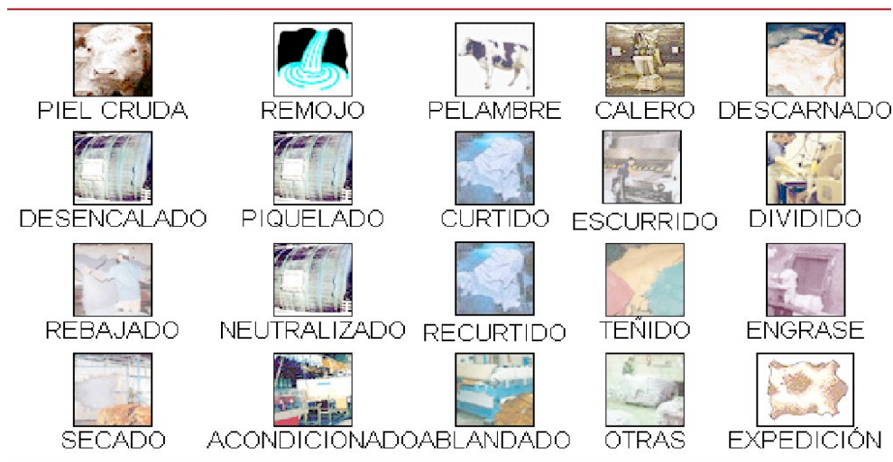
Figura 2: Flujograma de una curtiduría
