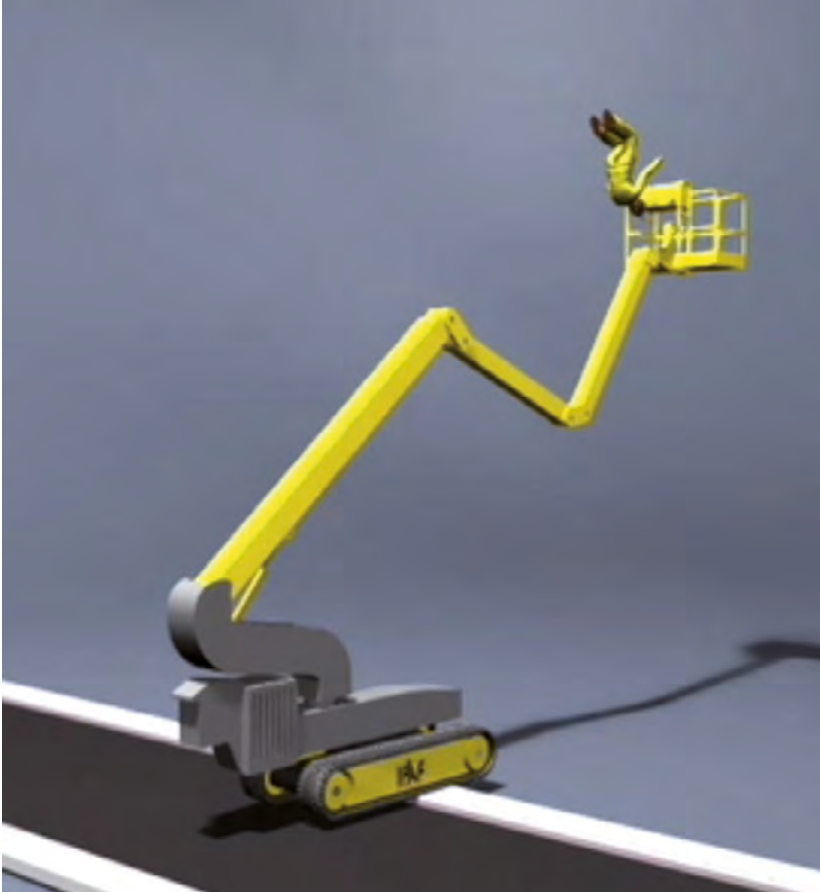
Figura 5.3. Efecto catapulta por pasar encima de un bordillo
