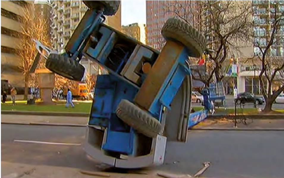
Figura 5.28. Accidente de una PEMP a consecuencia de la fatiga
