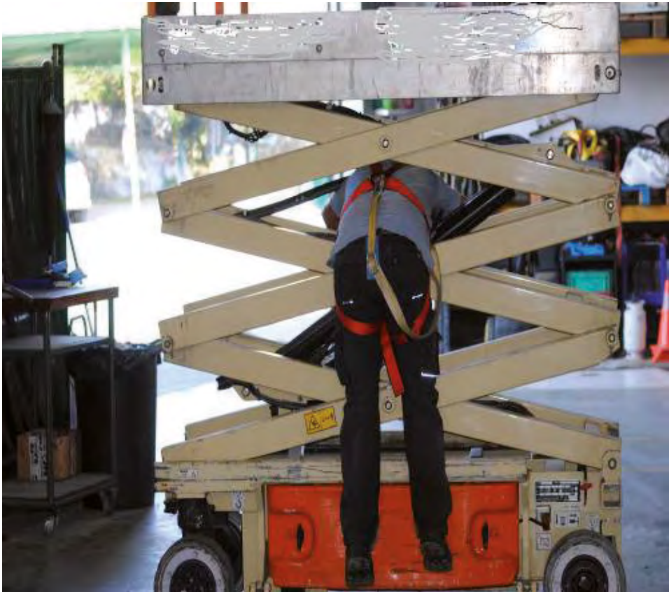
Figura 5.15. Atrapamiento por exceso de confianza en una tarea habitual de mantenimiento
