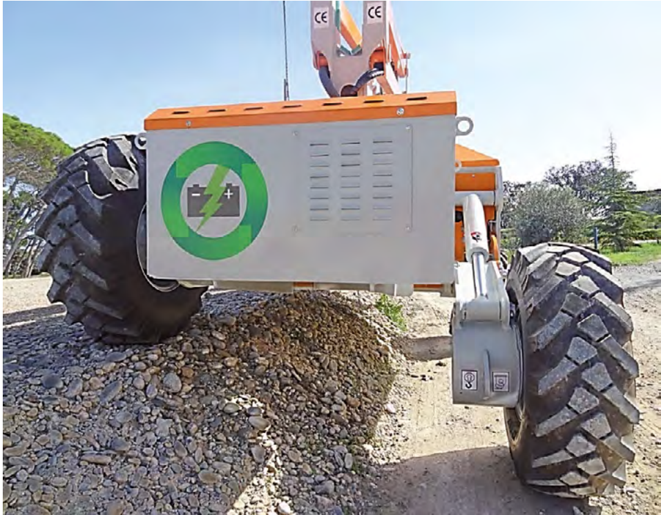
Figura 7.25. PEMP autonivelante, para trabajar en superficies desniveladas
