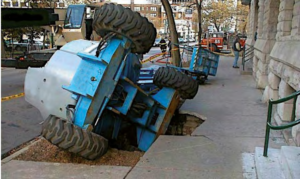
Figura 5.26. No considerar las características del suelo y el peso de la PEMP
