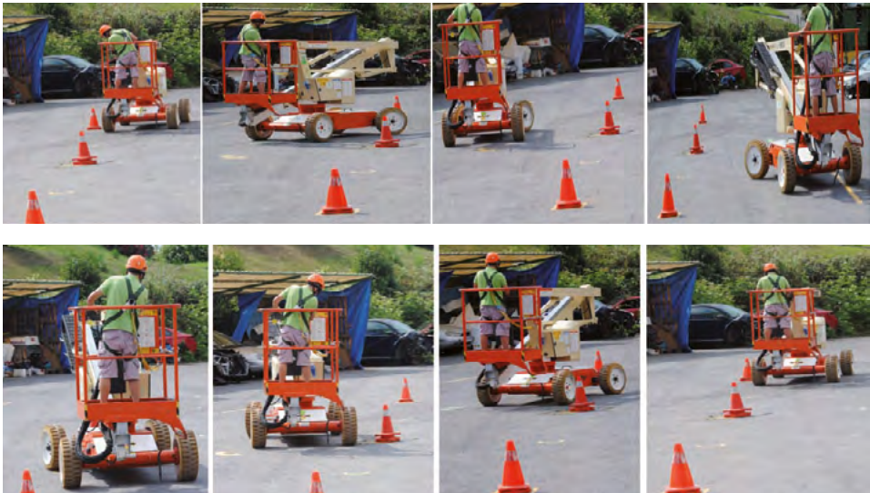
Figura 3.3. Desplazamiento hacia adelante/hacia atrás con gafas simulando grado de alcoholemia (tiempo 1'40")
