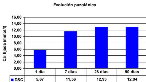
**Figura 4:** Actividad puzolánica de cerámico reciclado finamente molido: 1ª muestra
