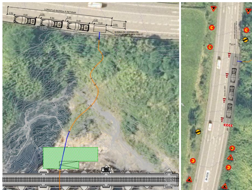
Figura 2. Tubo para hormigonado del dique y señalización BI-2235
