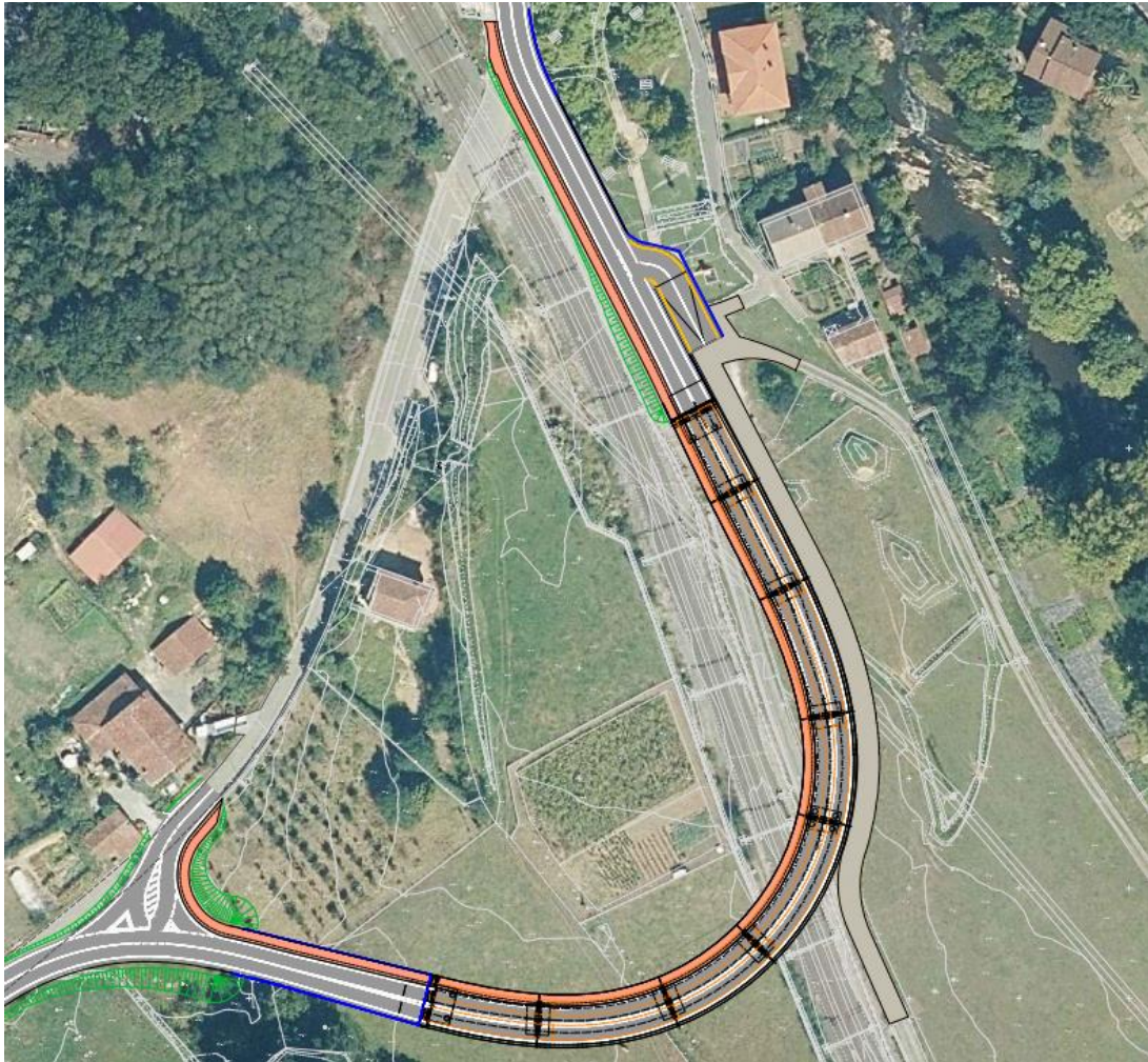
Planta del viaducto proyectada
