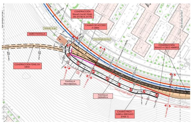
En la segunda fase es necesario una pantalla de 10,00 m de longitud y 14,00 m de altura aproximada que permita la ejecución del falso túnel sin afección a la instalaciones de gas existente.
