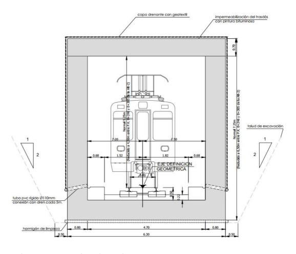
La ejecución de este tramo de falso túnel está condicionada por la presencia de la regata de Morlans que deberá ser repuesta.
