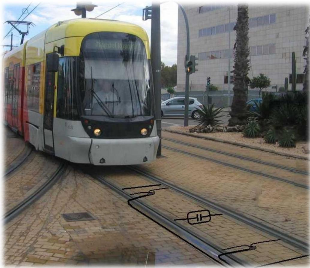
**Ilustración 2. Ejemplo de circuito de vía tranviario embebido**
