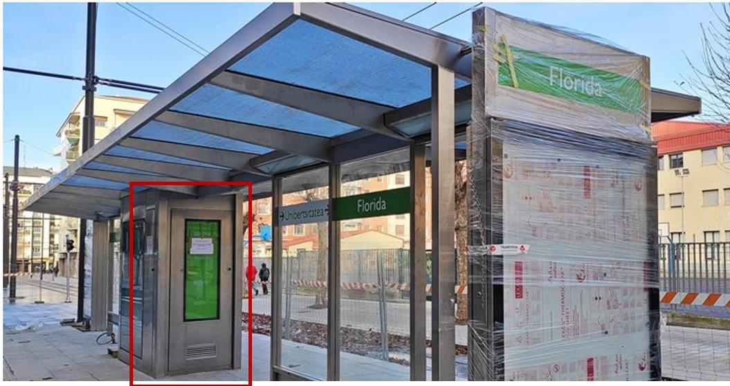
**Ilustración 11. Ejemplo de bloque técnico en parada tranviaria**
