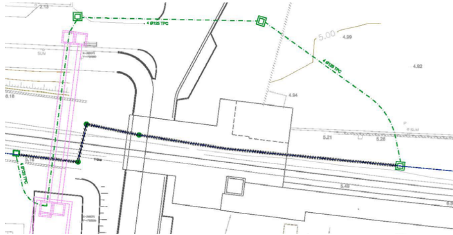
Figura 2. Desvío de cables de F.O. titularidad de Euskaltel.
