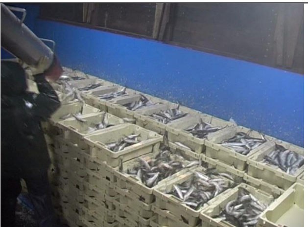
Llenando las cajas por medio del tubo que recoge el pescado que baja desde el colector
