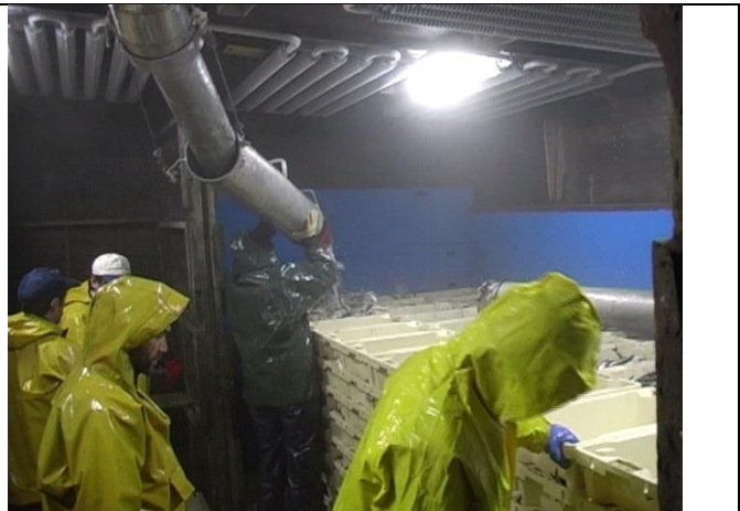
Llenando las cajas por medio del tubo que recoge el pescado que baja desde el colector
