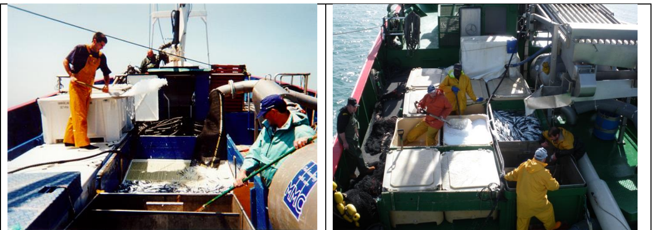
Paleado hielo a pescado depositado con la bomba de vacío en el colector (sin clasificadora)
