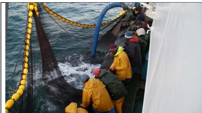
Tubo de bomba dentro del saco, listo para succionar el pescado
