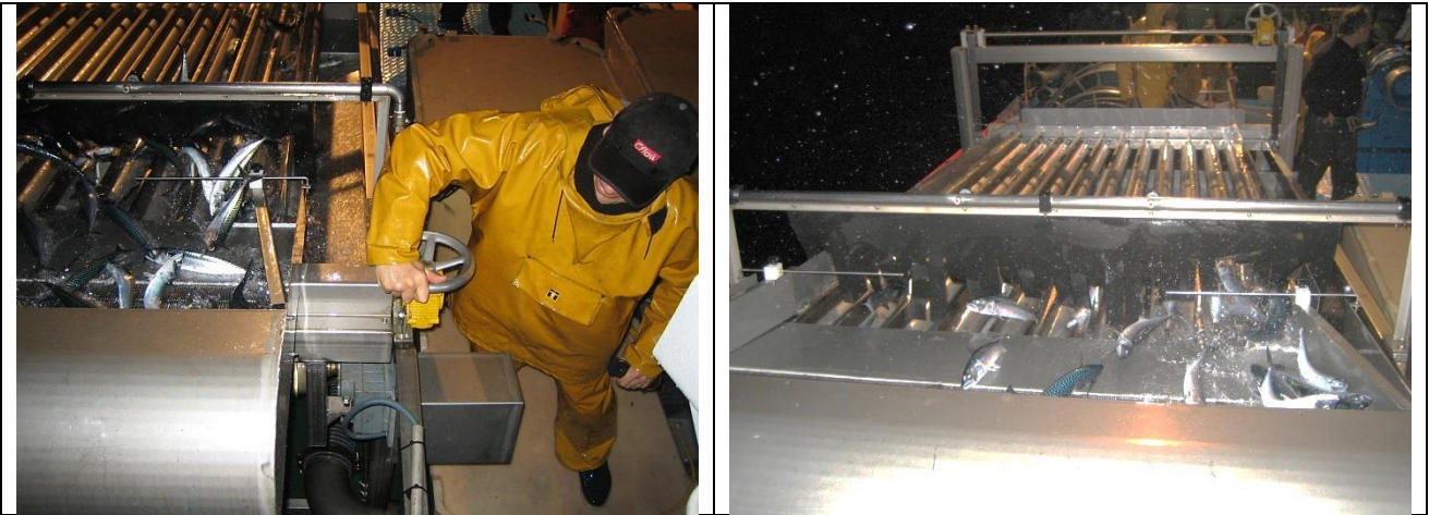
Clasificadora mecánica para la separación de especies
