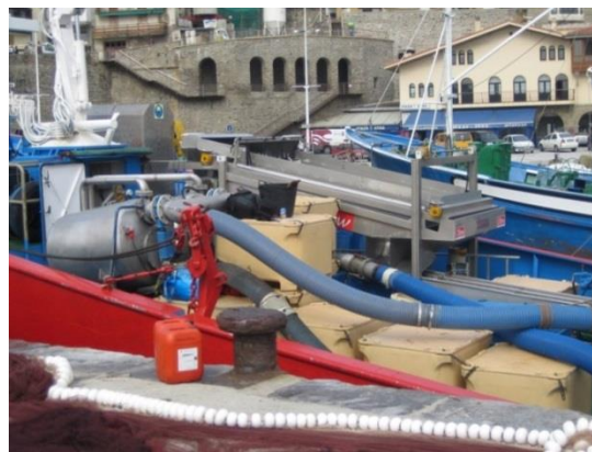
Embarque de pescado con bomba de vacío y posterior paso del pescado por clasificadora mecanizada
