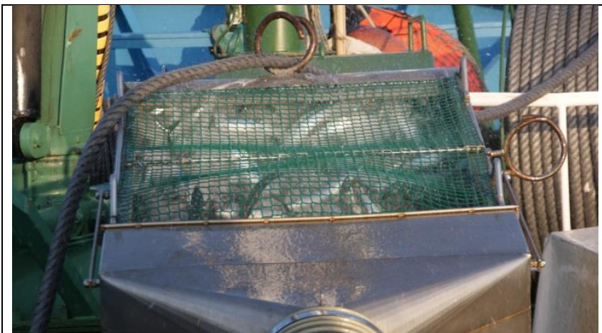
Dispositivo que recibe el pescado desde las bombas de vacío y permite eliminar el agua que viene junto al pescado.
