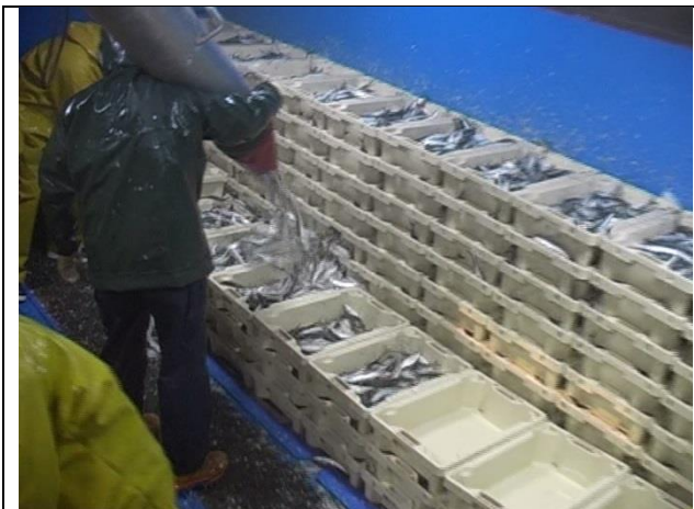
Llenando las cajas por medio del tubo que recoge el pescado que baja desde el colector
