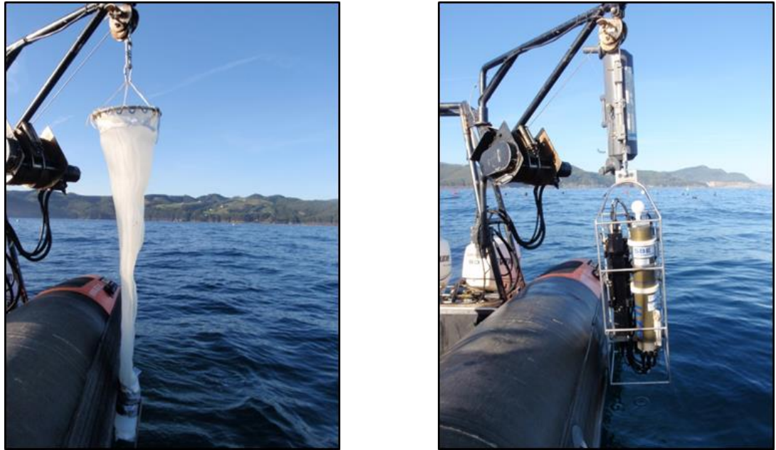
Figura 35. Imágenes del muestreo. Panel izdo.: red de fitoplancton de 20 \mu\text{m} , para el filtrado en vertical de la columna de agua. Panel dcho.: CTD para la realización de mediciones “in situ” y botella Niskin para la toma de muestras de agua a diferentes profundidades.
