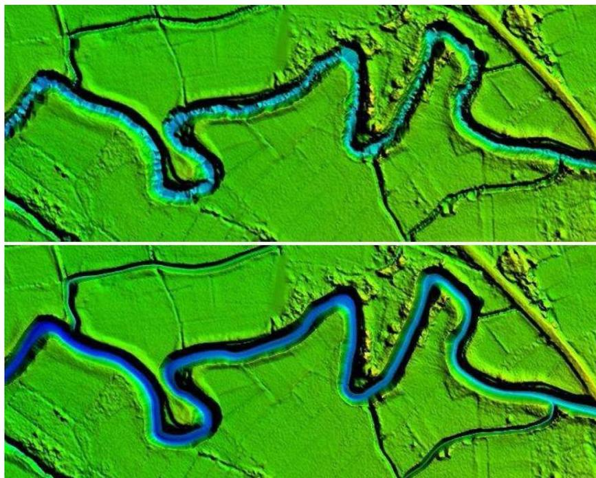
Figura 9. Modelo digital de elevaciones derivado de los datos LIDAR originales (arriba) y modelo corregido con datos batimétricos y topográficos (abajo)
