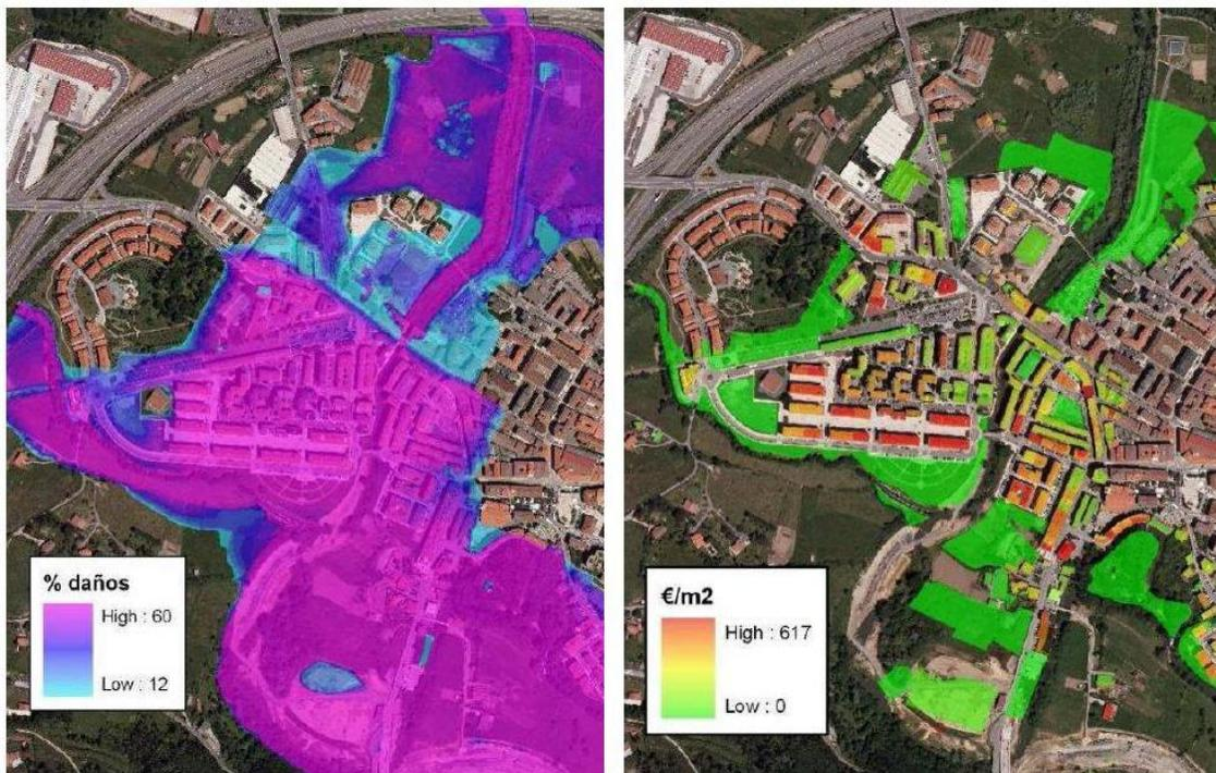
Figura 18. Cálculo de los daños en edificios en Mungia (Bizkaia): porcentaje de daño sobre el daño potencial máximo en función del calado (izquierda) y daños totales en edificios (derecha).
