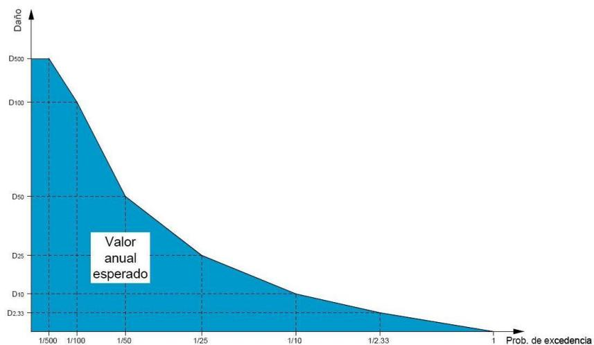
Figura 15. Variación del daño anual esperado en función de la probabilidad de excedencia (inverso del período de retorno). El valor anual de daño esperado es igual a la integral de la gráfica.
