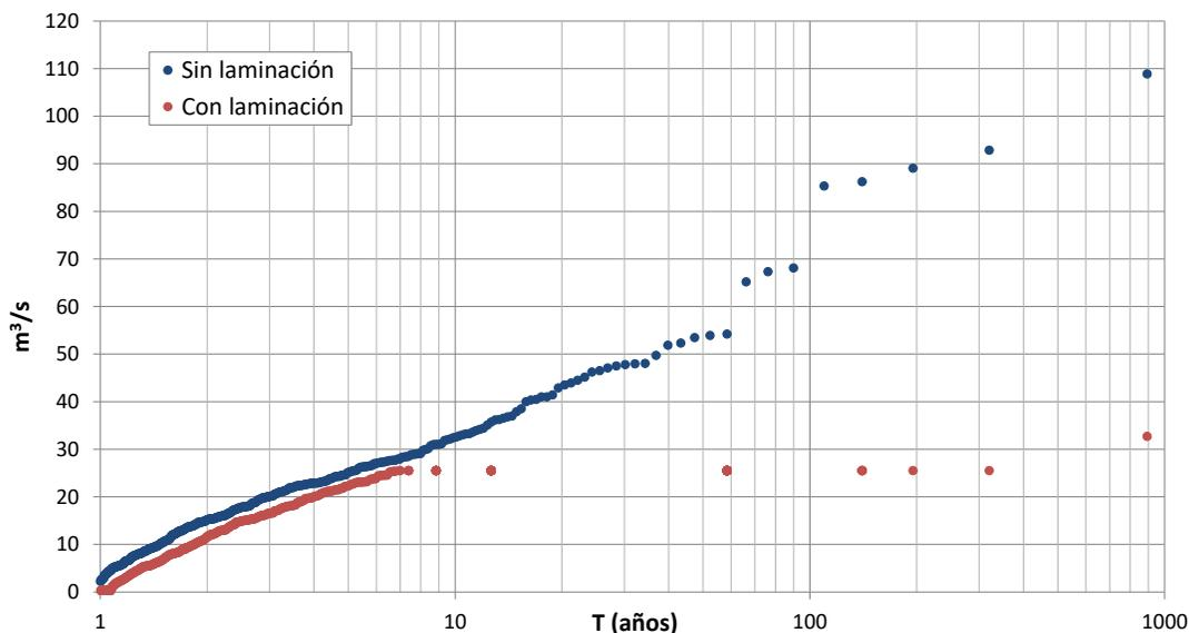
Figura 19. Comparación entre la serie de caudales de avenida del embalse de Ibai-Eder con laminación y en condiciones naturales.
