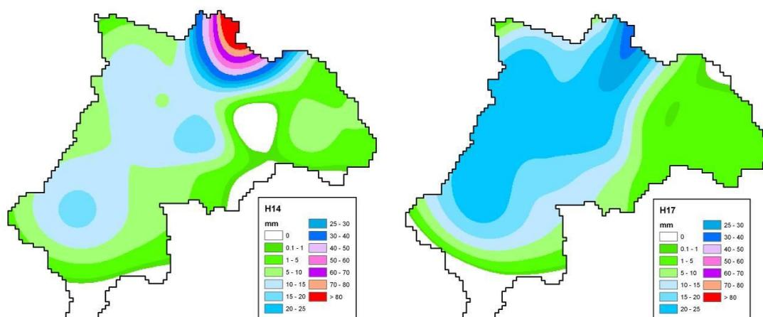
Figura 7. Ejemplos de distribuciones de precipitación para una tormenta sintética en la cuenca del Nervión-Ibaizabal.
