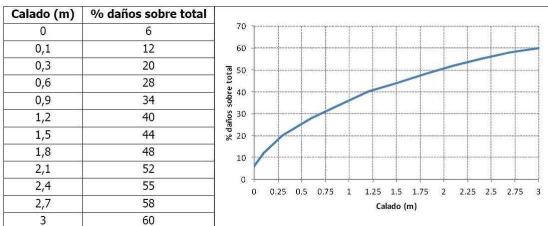
Figura 17. Relación entre el porcentaje de daños causados sobre el daño potencial máximo en función del calado.
