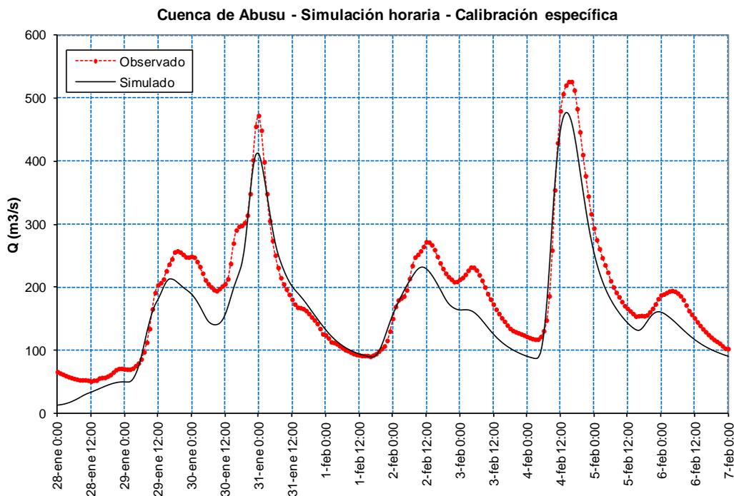
Figura 8. Ejemplo de calibración del modelo hidráulico con datos forométricos de un episodio de avenida en el río Ibaizabal a la altura de Abusu (La Peña).
