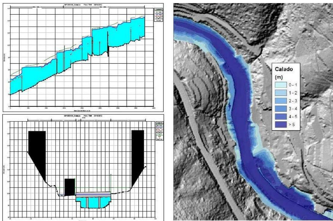
Figura 10. Resultados del cálculo hidráulico en el ARPSI de Sorluze (Gipuzkoa)
