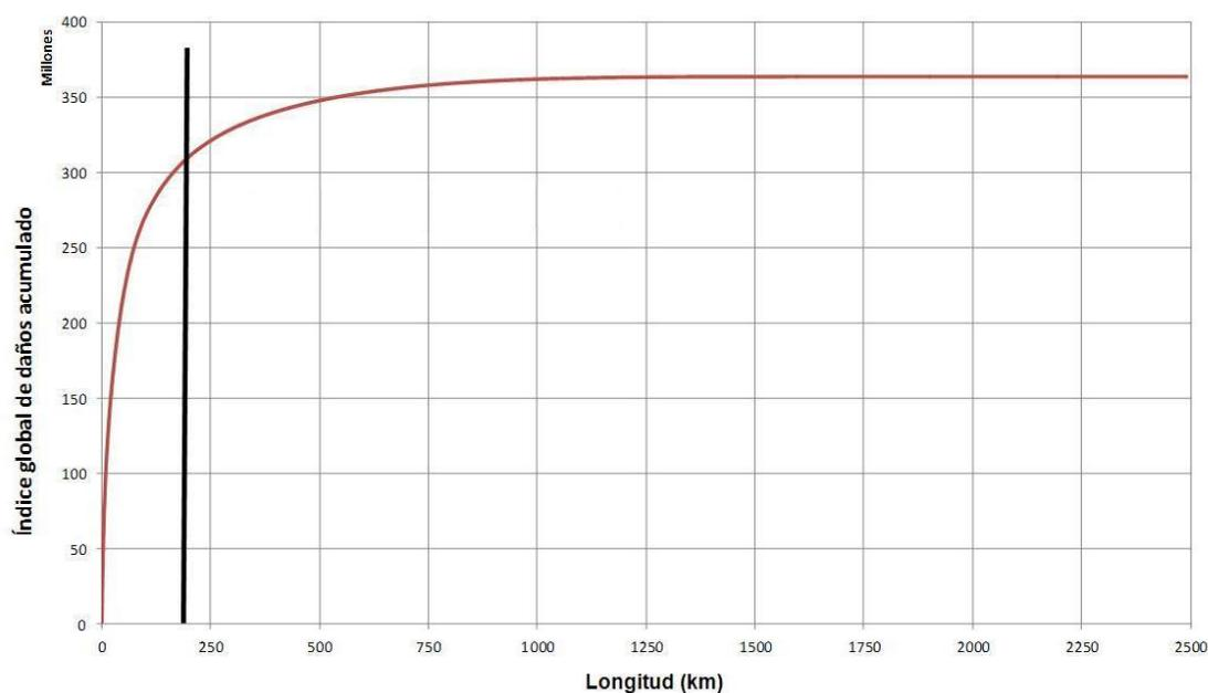
Figura 4. Variación de los daños acumulados producidos por inundaciones en función de la longitud de red hidrográfica acumulada en la CAPV. La línea negra vertical representa el umbral establecido para la definición de las ARPSIs, que incluyen todos los tramos situados a la izquierda de la línea negra.
