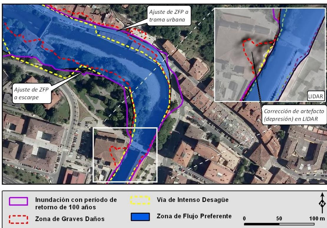
Figura 11. Delimitación de la ZFP del río Deba en Bergara unificando criterios hidráulicos y geomorfológicos
