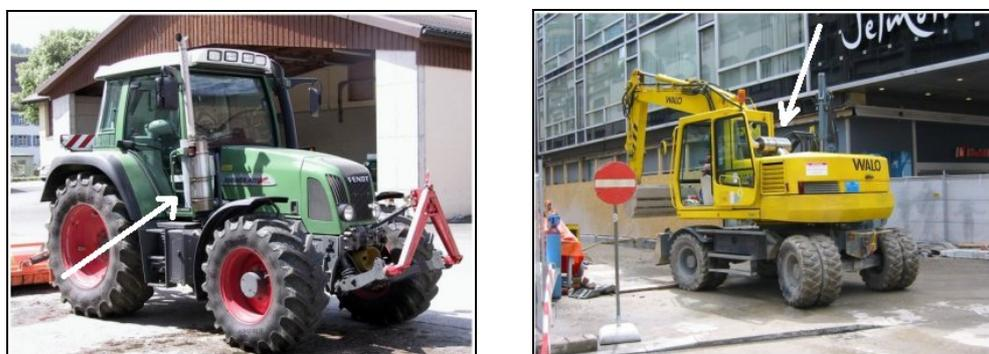
**Figura 4.5. – Filtros de partículas instalados en maquinaria agrícola y de obras**
