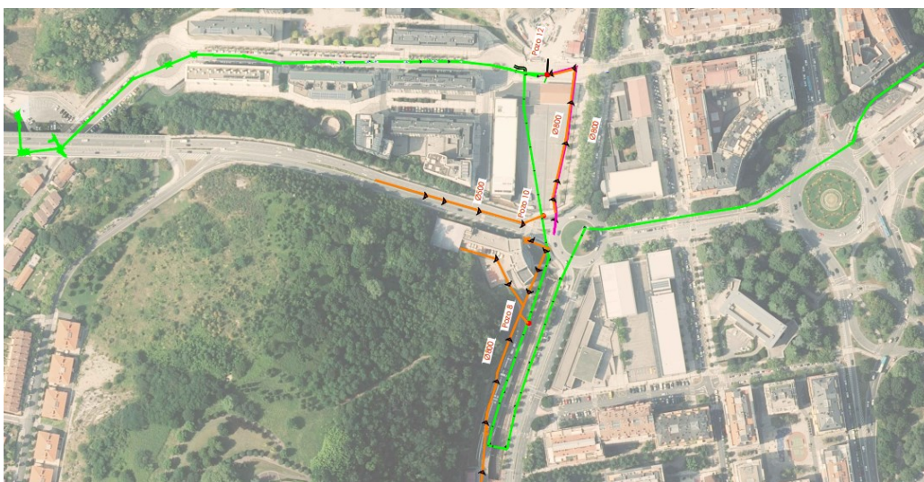
Kolektorearen proposamena berrezartzeko krokisa eta Morlans erreka proiektatua
