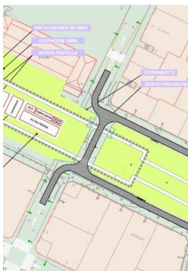
Una vez ejecutadas las pantallas que generan las interferencias se ejecuta la cubrición y se devuelve el tráfico a su trazado original. Desmantelando el desvío ejecutado para proseguir con la ejecución de las pantallas de hidrofresa.
