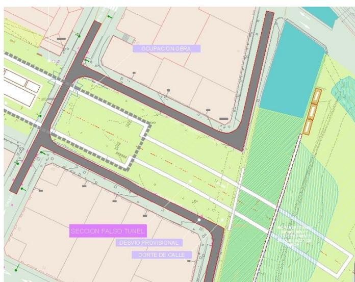
La ejecución de las pantallas de hidrofresa que albergan a la estación de Pasaia coincide en planta con la calle Gelasio Aramburu y con la regata Molinao. Esta interferencia genera el corte de la citada calle y su desvío como se observa en la imagen anterior.
