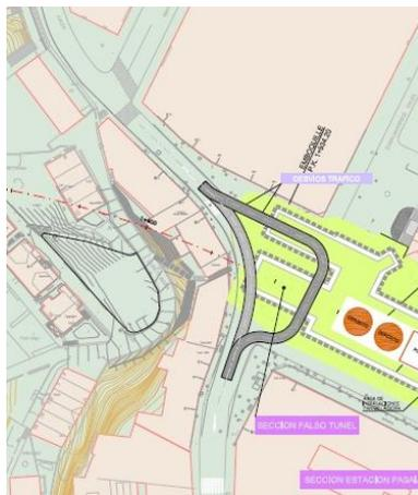
Una vez ejecutadas las pantallas que generan las interferencias se ejecuta la cubrición y se devuelve el tráfico a su trazado original. Desmantelando el desvío ejecutado para proseguir con la ejecución de las pantallas de hidrofresa.
