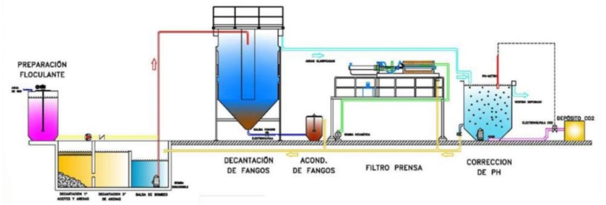
Tras la separación de los líquidos y los sólidos, el agua, siempre y cuando cumpla con las características adecuadas que aseguren la no afección al medio, podrá ser vertida a los colectores municipales o en función de los niveles de calidad obtenidos podrá ser vertida a la red de pluviales existente e indirectamente a la regata Morlans. En cambio, los sólidos, se extraerán de la balsa y se gestionarán en un punto autorizado, bien para someterlos a operaciones de eliminación o
