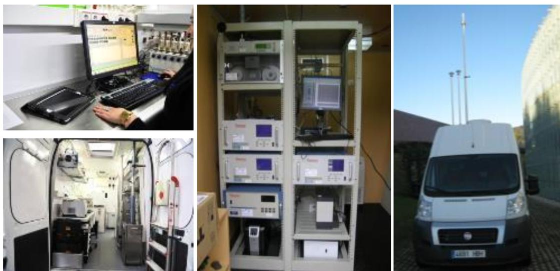
Figura 4. Equipamiento móvil de la Red de Calidad de Aire de Euskadi<sup>7</sup>. Fuente: Servicio de Aire.
