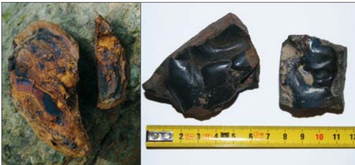
Ezk. Aitzatik (Asparrena) iritsitako limonita zatiak. Burdina-mean aberatsak dira alde hauek. Esk. Zepaditik iritsitako zepa jariakinak, haiek aztertzekeo prozesuan.
