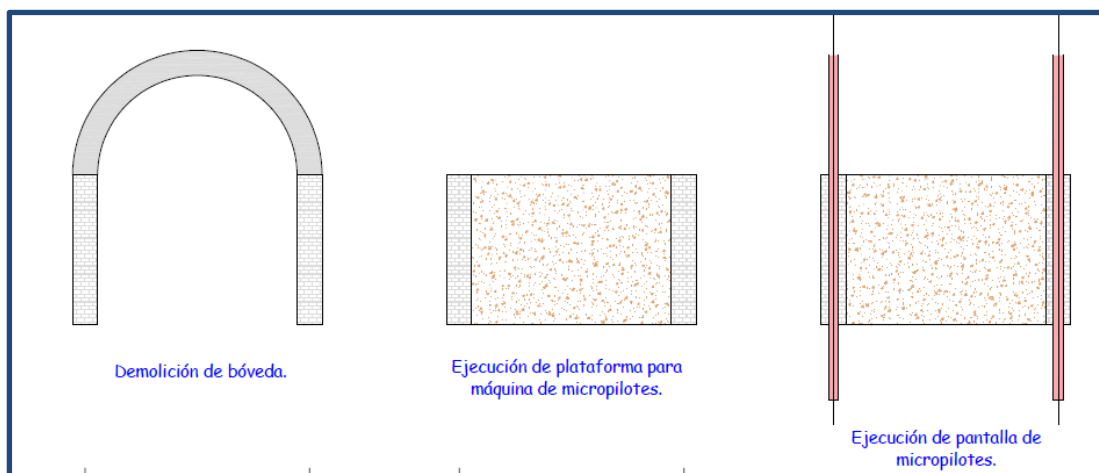
Iru dia 15. Mikropilote-makina jartzeko plataforma gauzatzeko eskema.
