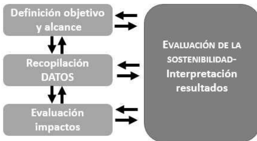
FIGURA 3. FASES DEL PROCESO DE ANALISIS DE CICLO DE VIDA, SEGÚN ISO 14044
