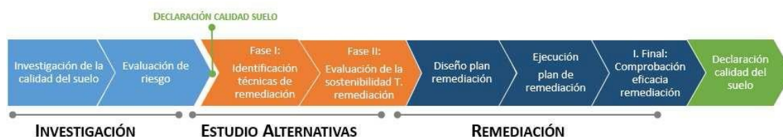
FIGURA 1. INSERCIÓN DEL ESTUDIO DE ALTERNATIVAS DE REMEDIACIÓN EN EL PROCESO GENERAL DE DECLARACIÓN DE LA CALIDAD DEL SUELO.
