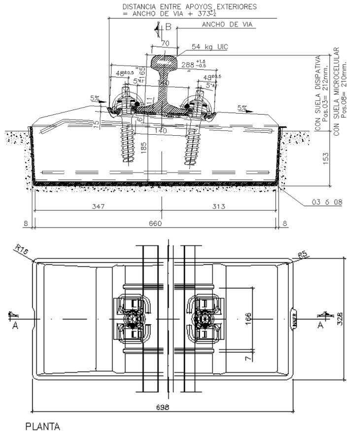
Por unidad de traviesa, los componentes del sistema de sujeción son los siguientes, además de las 4 espigas o vainas de anclaje de poliamida 6.6 con 30% de fibra de vidrio indicadas anteriormente:
