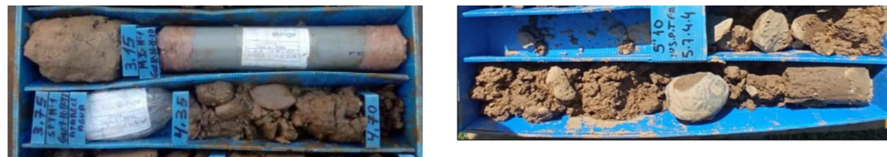
Figura 13: Nivel aluvial cohesivo en el sondeo SEI-05. Aluvial granular en el sondeo SEI-08
