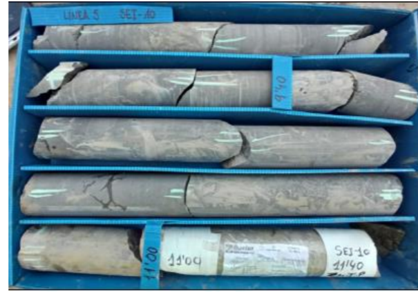
Figura 14: Sondeo SEI-11: alternancia de areniscas y limolitas (Complejo Supraurgoniano). Sondeo SEI-10: Limolitas grises (Complejo Urgoniano).
