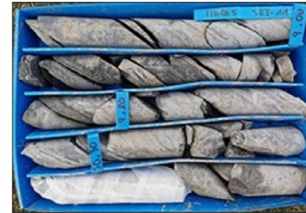
Irudia 14: SEI-11 zundaketa: hareharriak eta limolitas txandakatzea (konplexu Supraurgoniarrak). SEI-10 zundaketa: limolita grisak (Urgoniar konplexua).
