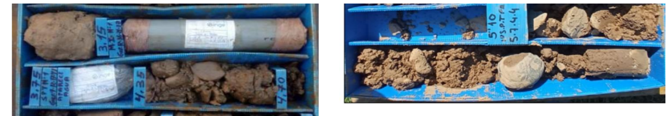
Irudia 13: alubioi-maila kohesiboa SEI-05 zundaketan. Alubial granularra SEI-08 zundaketan
