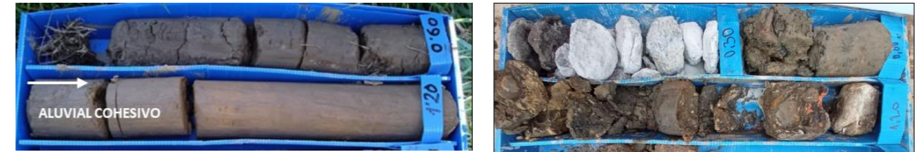
Irudia 12: landare-lurraren maila, lurzoru alubialaren gaineko SEI-08 zundaketan (0.60 m). SEI-09 zundaketan hormigoipeko betelanen mailak
