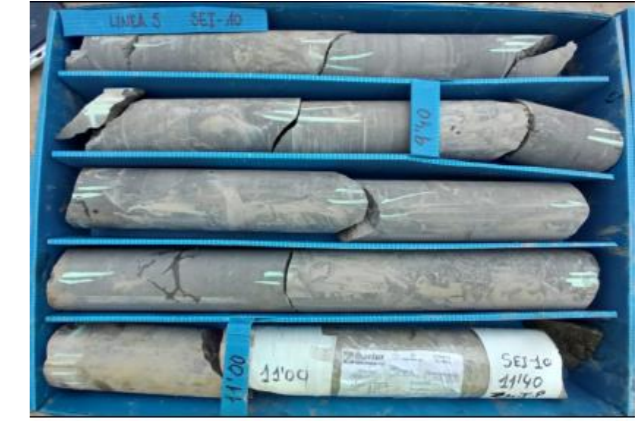
Irudia 14: SEI-11 zundaketa: hareharriak eta limolitas txandakatzea (konplexu Supraurgoniarrak). SEI-10 zundaketa: limolita grisak (Urgoniar konplexua).
