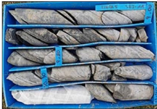
Figura 14: Sondeo SEI-11: alternancia de areniscas y limolitas (Complejo Supraurgoniano). Sondeo SEI-10: Limolitas grises (Complejo Urgoniano).
