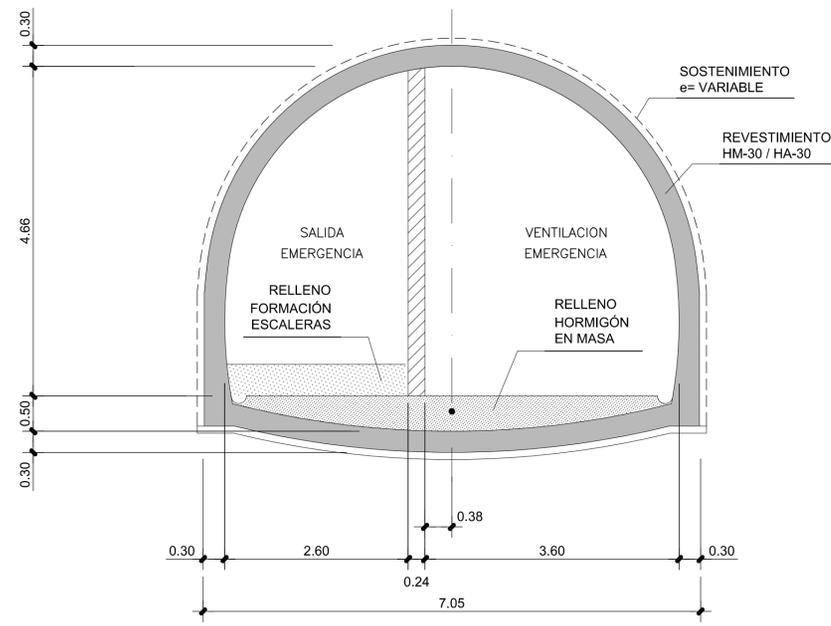
SECCIÓN TIPO 2: VENTILACIÓN Y SALIDA DE EMERGENCIA
