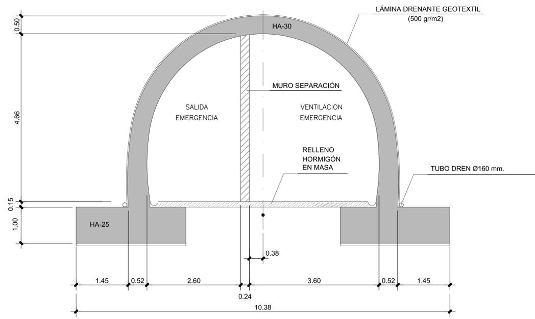
SECCIÓN TIPO 1: FALSO TÚNEL
