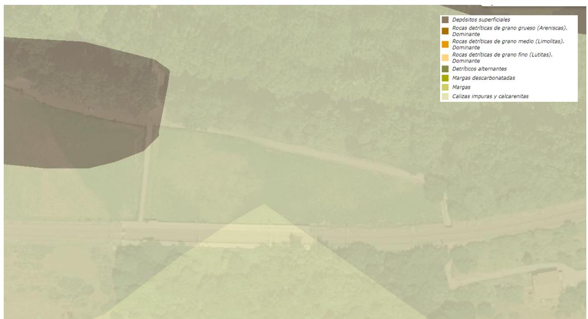
En el área de estudio los rellenos cartografiados corresponden principalmente con depósitos aluviales superficiales asentados en el margen del río Ibaizabal. Se suponen rellenos de suelo coluvial asentados a lo largo de los años en el humedal de Urdaibai.
