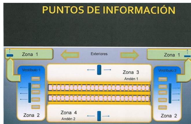
La transmisión de la imagen se va a realizar desde el servidor existente vía ethernet, hasta las pantallas TFT de los teleindicadores de vestíbulo.
