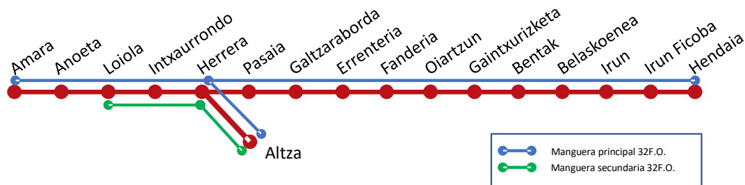
2. irudia: Zuntz optikoko azpiegitura Amara-Hendaia zatian (egungo egoera)
