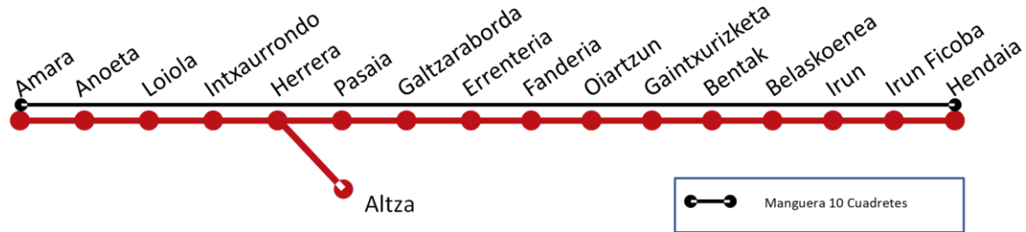
Figura 5: Infraestructura de cuadretes en el tramo Amara - Hendaia
