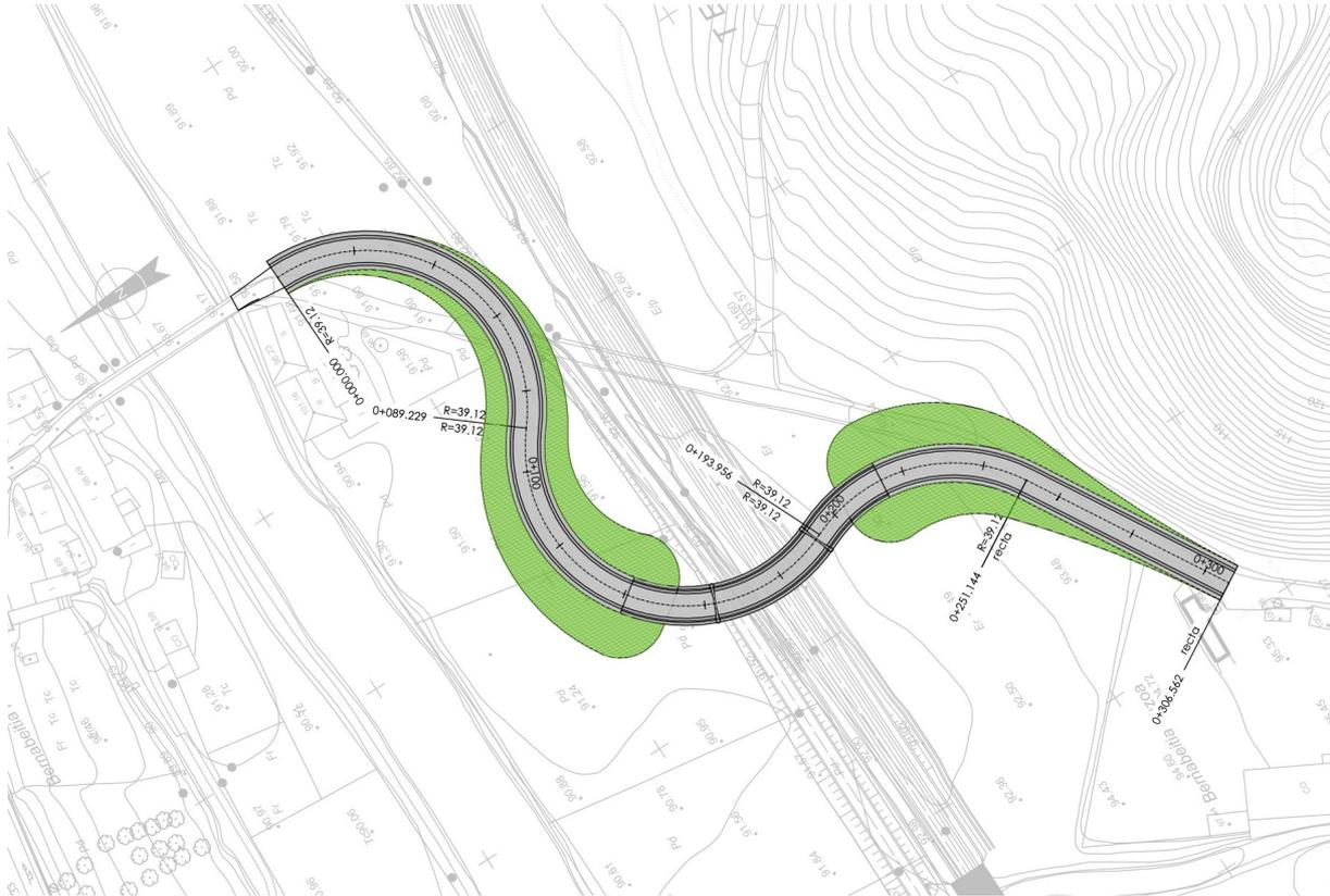
La alternativa 3 no genera sobreelevaciones de la lámina de agua superiores a los 10 cm. Sin embargo, para que la alternativa 3 fuera viable sería necesario incrementar la longitud de la estructura, pues uno de los estribos se sitúa en la mancha de inundación de 100 años.
