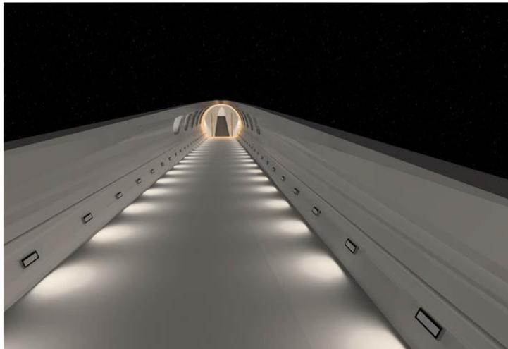
Asimismo, llegando al ascensor se ha dispuesto un anillo led para iluminar intensamente la pared del fondo, donde está situada la puerta de cristal de acceso al ascensor, resaltando su forma circular.
