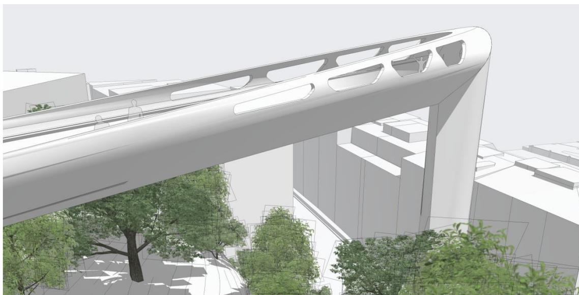
En el nudo la sección se completa, y cubre totalmente el paso en el emboquille del ascensor, resguardando a los peatones, y enmascarando la cubierta del ascensor. La forma del pórtico es compacta, lo que ayuda a dar seguridad a los usuarios, dada la altura del mismo.
