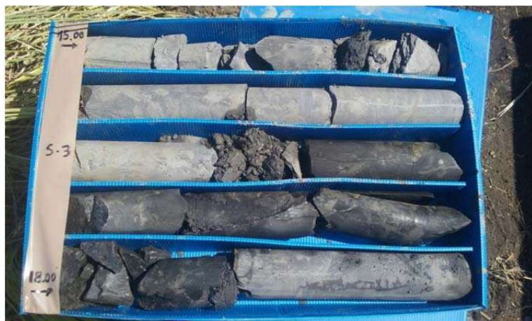
Fotografía 2: Niveles margosos localizados en los sondeos
