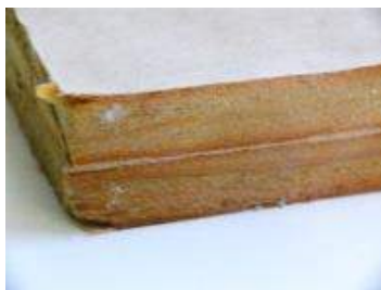
Figura 3.14- Panel de lana de roca con tecnología aerogel
