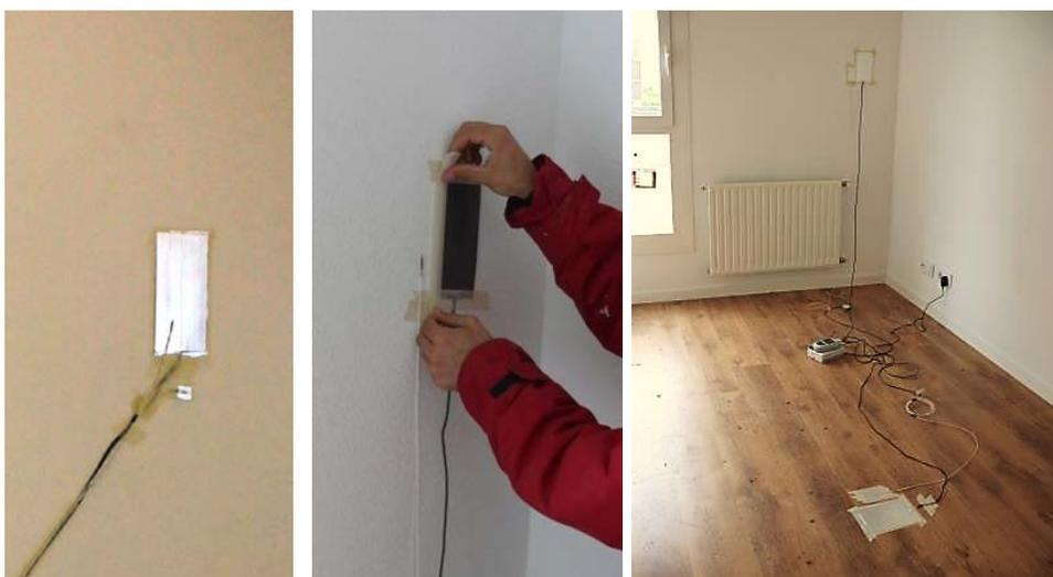
Figura 17. Montaje de la instrumentación en el interior de una fachada
