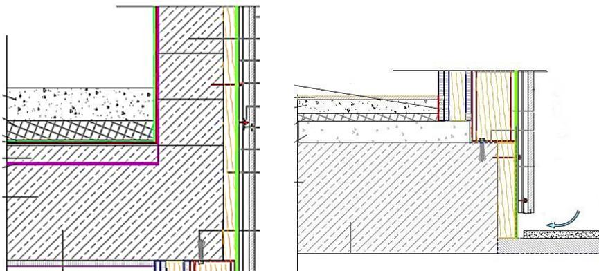
Secciones tipo del antepecho de cubierta (izquierda) y suelo (derecha)
