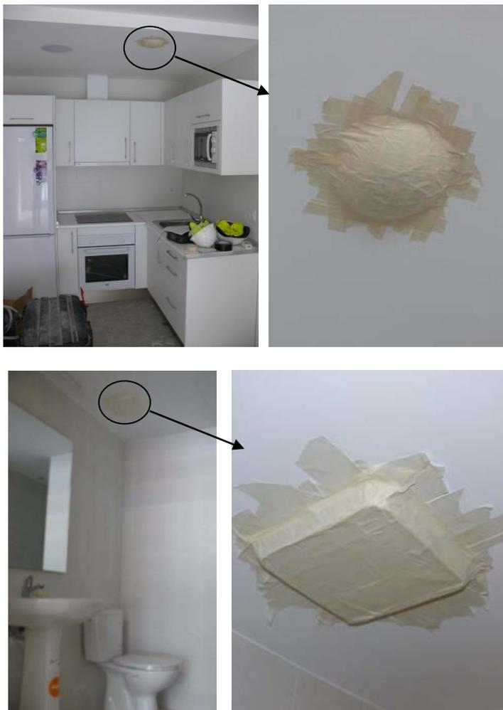
Figura 19. Sellado temporal de rejillas de admisión (salón y habitaciones) y de extracción (Cocina y baños) durante el ensayo de estanqueidad al aire (Método B de la Norma UNE-EN 13829:2002)
