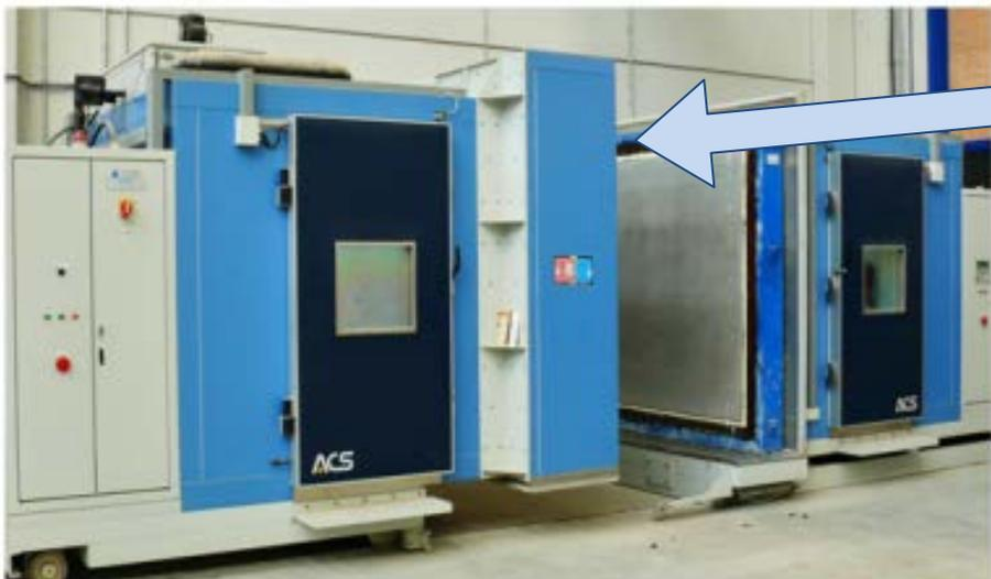
Figura 25. Montaje de la muestra dentro de la caja caliente guardada
