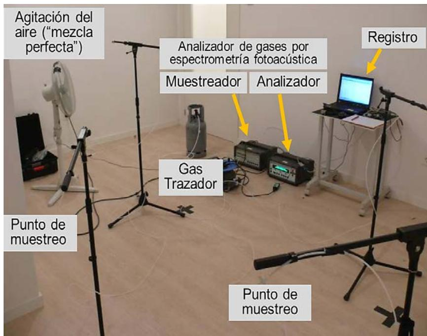
Figura 20. Ensayo de comprobación de caudales de ventilación mediante gases trazadores
