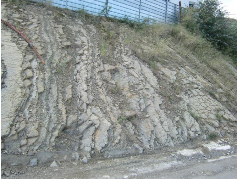
Ilustración 7: Detalle flysch (litotipo FDC). Alternancia de margas y bancos cm de calcarenitas. (GM III-IV).
