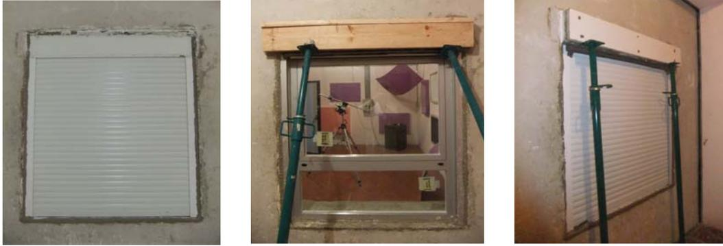
Además se ha ensayado el conjunto de ventana con sistema de microventilación (II) activado, es decir la hoja abierta en posición de microventilación y los conjuntos de ventanas con aireador (III y IV), con el aireador tapado, en las situaciones B, C, D a fin de poder comparar los distintos tipos de sistemas de aireación integrados en estas soluciones analizadas.
