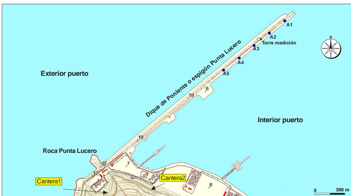
Figura 2. Localización del parque eólico en el dique de Punta Lucero del Puerto de Bilbao e identificación de algunos puntos relevantes en la zona. A1, A2... indica la ubicación de los aerogeneradores.
