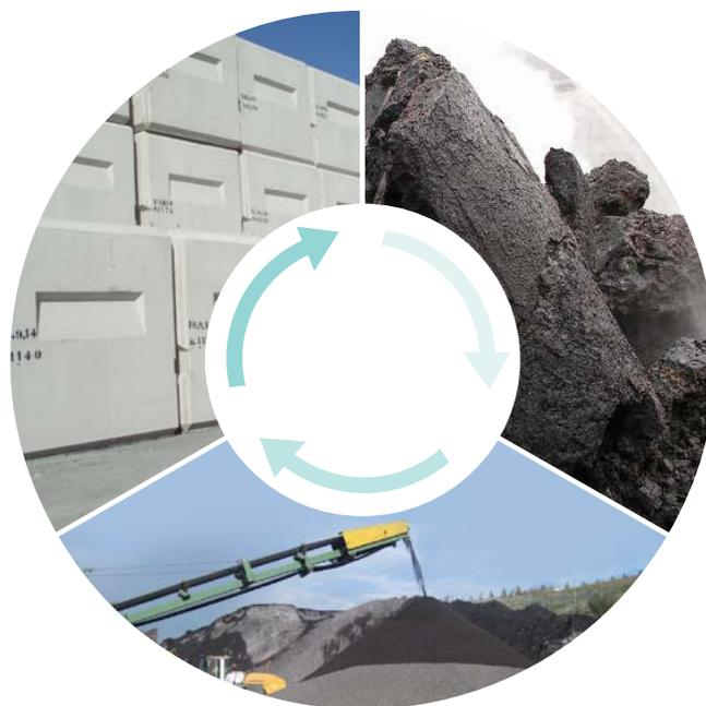
**Escorias de acería tratadas y transformadas en materia prima para elaborar bloques de hormigón utilizados para la escollera del puerto de Bilbao.**
