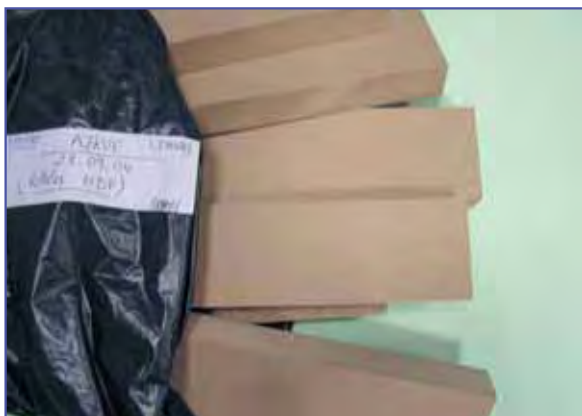
Fig 15: Retales MDF-tablero de fibras.
