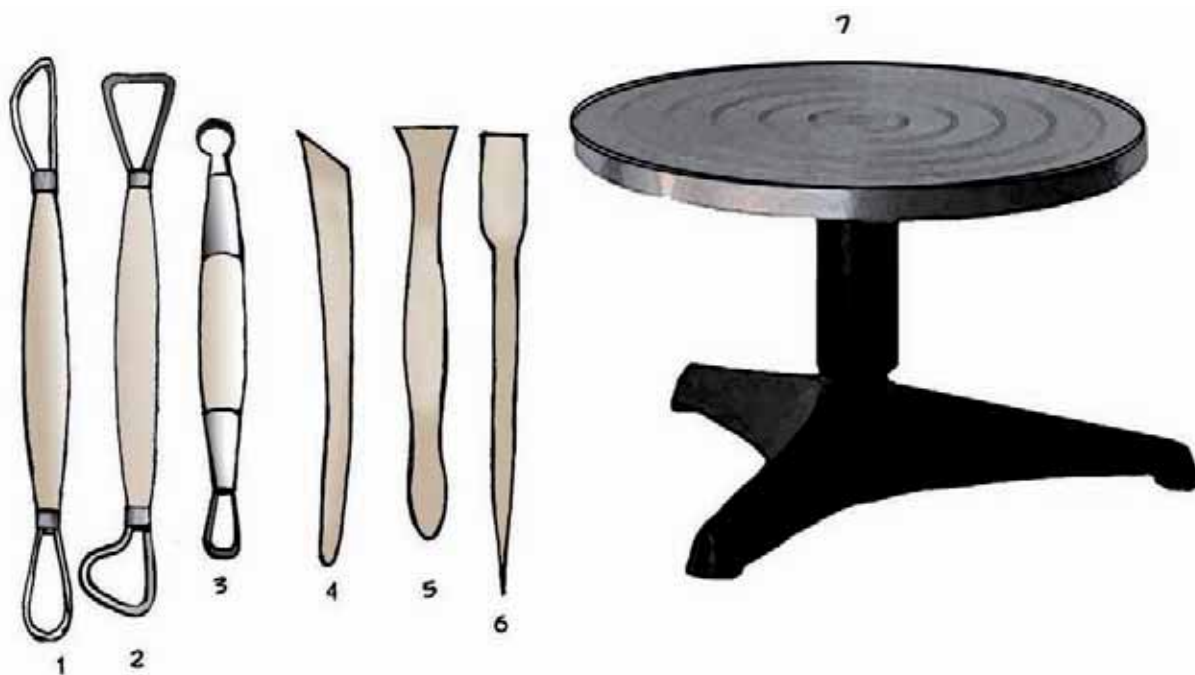
Modelatzeko tresnak: (1) (2) eta (3), hustugailuak; (4), (5) eta (6), modelatzeko zotzak; (7), pieza txikiei eusteko torneta. Goiko plater biribilean kokatuta, erraz biraraziko diegu piezei.
