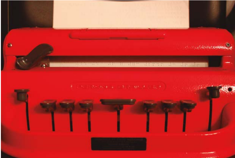
Foto 31. Máquina Perkins para escritura en Braille.
