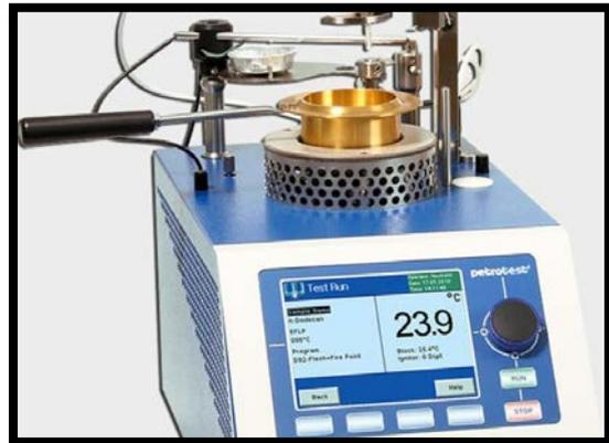
En nuestro laboratorio, la fuente de ignición de este método es una llama y no eléctrica como el anterior, y se ha tenido en cuenta que la aplicación de la llama de prueba puede causar un halo azul o una llama agrandada antes del punto de inflamación real. Esto no es un punto de inflamación y debe ser ignorado.
