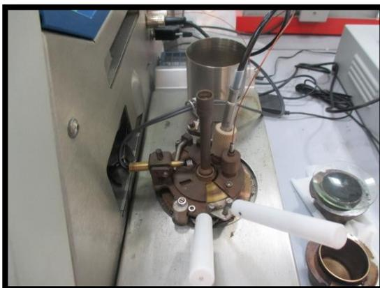
La copa es calentada durante el ensayo (incrementando 5 a 6°C /min.) y la fuente de ignición se introduce en la copa cada 1°C hasta que se produce la inflamación.
