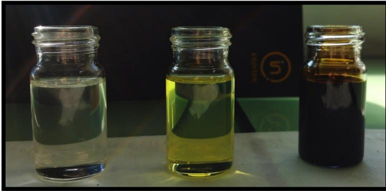
En la imagen anterior, se muestra el aspecto de la gasolina 95 a la izquierda, el gasóleo A en el centro y la mezcla 1:1:1 de Gasolina - Gasóleo - FO
