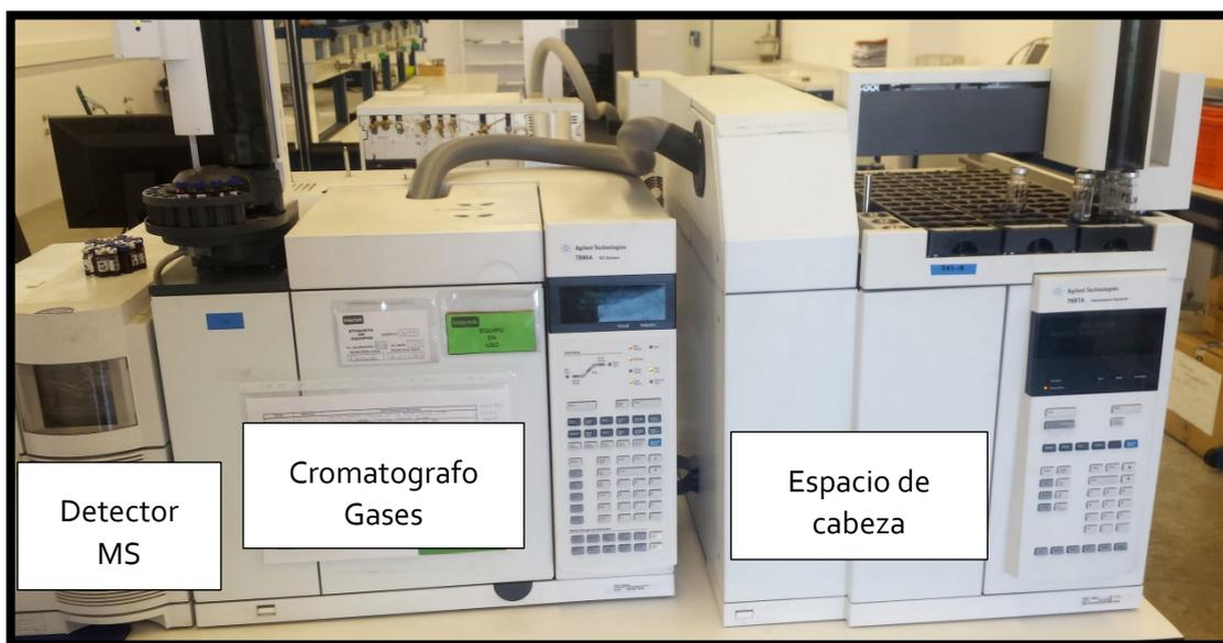
La espectrometría de masas está basada en el diferente comportamiento que presentan los iones que se forman por las diferentes técnicas de ionización, al atravesar campos eléctricos y magnéticos. Así dichos iones son separados en función de su relación masa/carga ( $m/z$ ) y detectados posteriormente.
