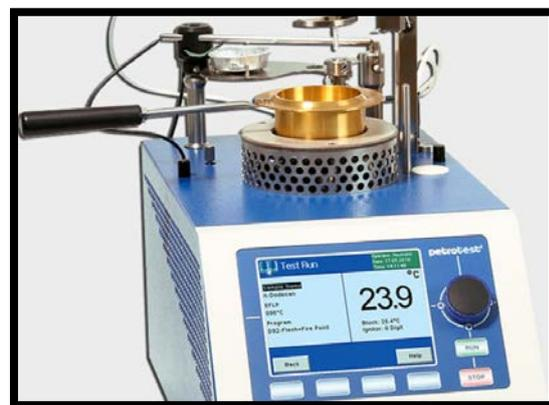
Se añaden 70 g de muestra a la copa o vaso de ensayo que se va calentando a rango constante y aproximando la llama cada intervalo de  $1^{\circ}\text{C}$  hasta el que se produzca el destello. Se registra la temperatura como punto de inflamabilidad y se continúa calentando hasta obtener que la llama se mantenga durante al menos 5s y se registra esa temperatura como Fire Point o punto de fuego.
