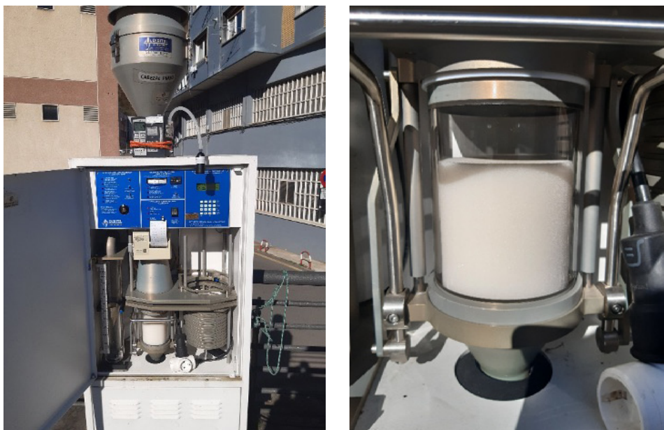
Figura 24. Equipo captador de partículas Digital High Volume con filtros y puff. A la derecha el puff de poliuretano para captar el contaminante
