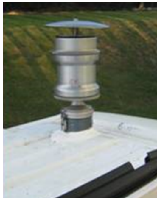
Figura 16. Equipo captador de partículas Derenda LVS3.1 ubicado en el interior de la UM7 con cambiador de filtros y detalle del cabezal en el techo de la unidad móvil por donde entra la muestra
