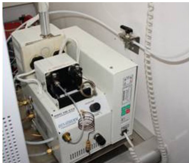
Figura 5. Equipos de Desorción Térmica ACEM9305 y GC/MSD 5975T, donde se observa el dispositivo para control manual (centro derecha) y el mástil de toma de muestra (derecha superior), así como ampliación del equipo ACEM9305 con detalle de la válvula de conmutación Indoor/Outdoor
