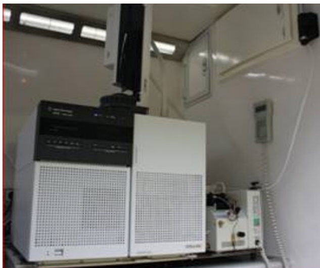
Figura 5. Equipos de Desorción Térmica ACEM9305 y GC/MSD 5975T, donde se observa el dispositivo para control manual (centro derecha) y el mástil de toma de muestra (derecha superior), así como ampliación del equipo ACEM9305 con detalle de la válvula de conmutación Indoor/Outdoor
