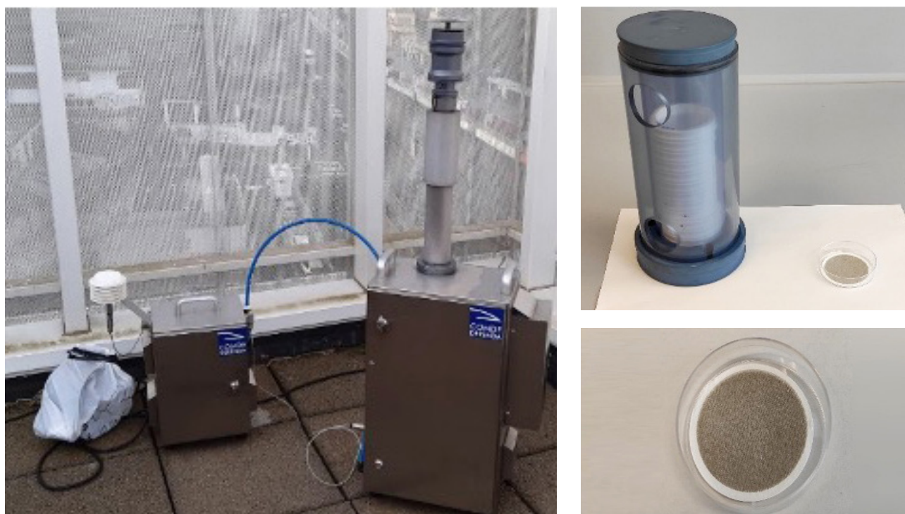
Figura 15. Equipo captador de partículas Derenda ubicado en el Hospital de Eibar, soporte de filtros y filtro para muestreo de partículas
