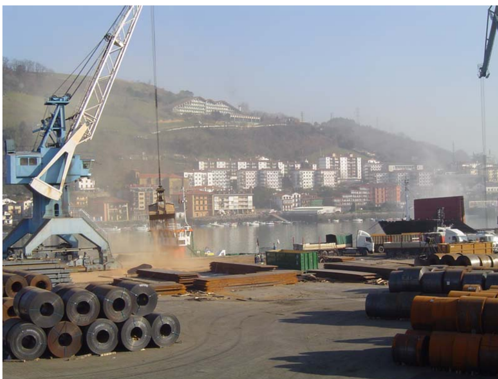
A.5. irudia – Material partikulatuaren esekitzea, itsasontzien zamaketa-lanak egin bitartean.
